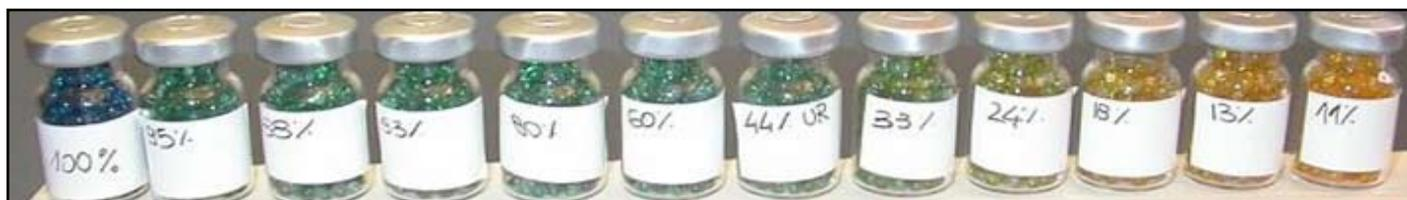
Figure 14 Série d'hydratation du silicagel. Hydratation totale à partielle (de gauche à droite) (MTSN)
