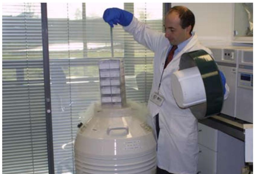
**Figure 20** Cryopréservation dans l'azote liquide. (© RBGK)
