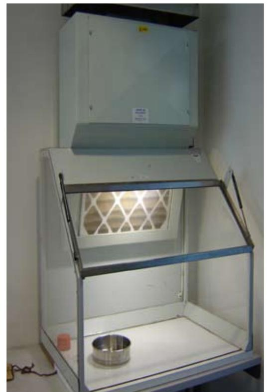
**Figure 6** Hotte d'air pur pour le nettoyage des graines. (© RBGK)
