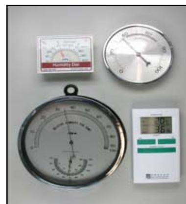
**Figure 17** Gamme d'hygromètres mécaniques et électroniques. (© RBGK)
