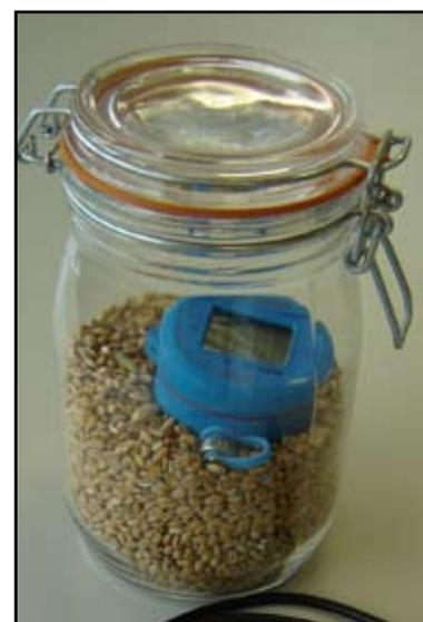
**Figure 16** Enregistreur de données notant l'eRH dans un récipient hermétique de graines. (© RBGK)
